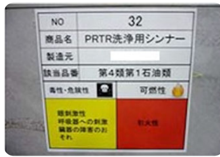
掲示パネルにて有害性・危険性を周知 (コクヨ芝山工場)
