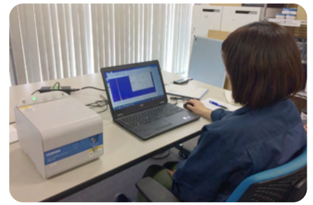
蛍光X線分析装置で重金属の有無を確認 (コクヨ本社)
